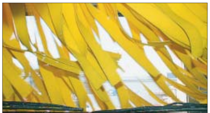
Zum Schluss saugen Schaumlappen die Restfeuchte von der Carosserie.
