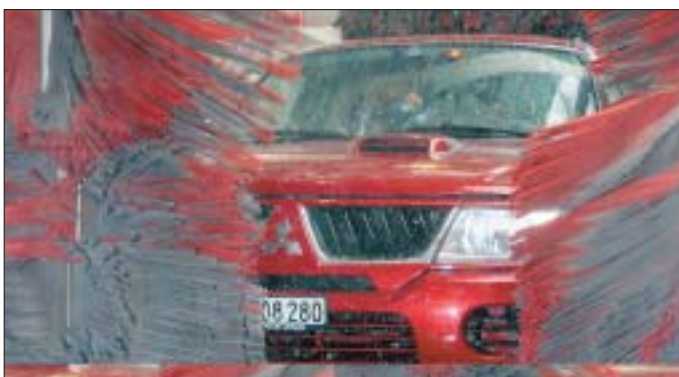
Die Anlage reinigt die Fahrzeuge mit Textilstreifen, deshalb gibt es keine Kratzer.
