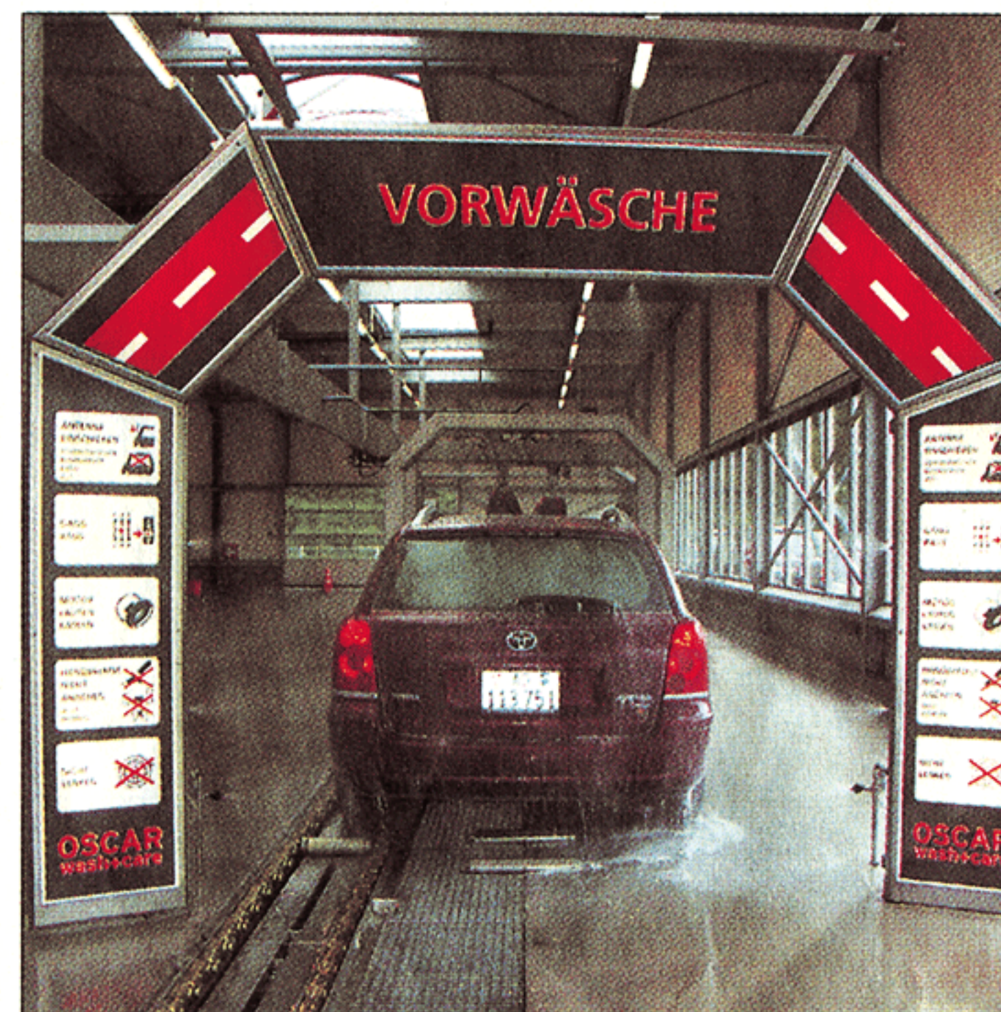
Ein breites Gliederband zieht das Auto durch die Vorwaschanlage.
